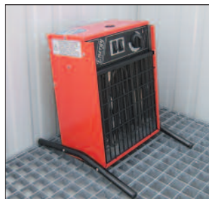
Umluft-Heizung 5 kW, nicht ex-geschützt
