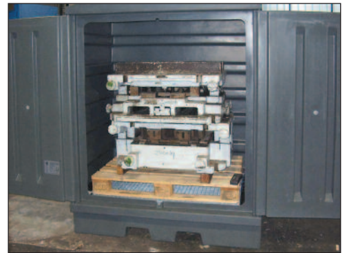
PE-200-EP8 unter einer Prüflast von 2400 kg
